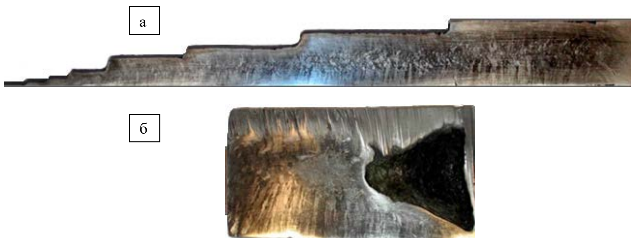
Рис. 15 – Макроструктура тела (а) и прибыльной части (б) опытной модельной отливки
